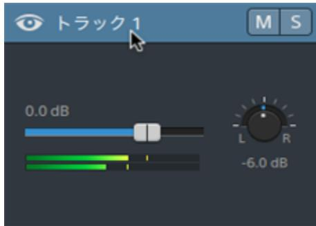
トラックに複数のチャンネルが存在する場合は、チャンネルごとに個別のコントロールが表示されます。トラック全体のレベルを調整するには、青色の【ボリューム】フェーダーを使用し、トラックのレベルに対する各チャンネルの効果を調整するには、オレンジ色の【ボリューム】フェーダーを使用できます。詳しくは、[134 ページの "マルチチャンネル オーディオの操作"](#)を参照してください。
